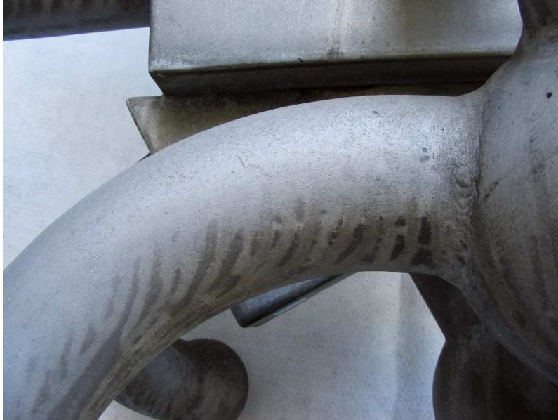
Bogenansatz unter den geschweißten Blechkörpern vor der Bearbeitung
